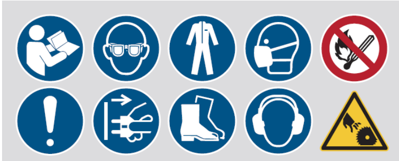
Abb. 1-1: Sicherheitskennzeichnung - Gebotszeichen: Gebrauchsanweisung beachten, Augenschutz benutzen, Schutzkleidung benutzen, Maske benutzen, Allgemeines Gebotszeichen, Netzstecker ziehen, Fußschutz benutzen, Gehörschutz benutzen | 2 Verbotssymbole: Keine offene Flamme, Feuer, offene Zündquelle und Rauchen verboten! | 3 Warnzeichen: Warnung vor Gefahr durch rotierendes Sägeblatt
