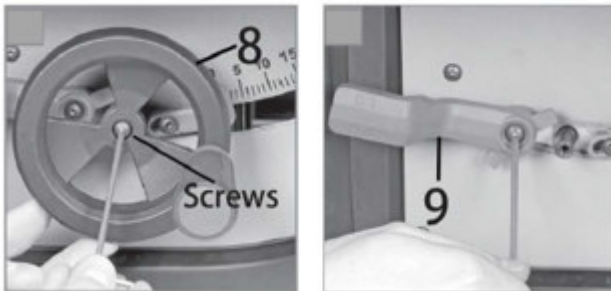
Abb.5-4: Nachjustieren der Klemmkraft des Verriegelungshebels
