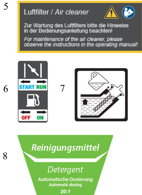
Abb. 1: Sicherheitskennzeichnungen: 1 Gebots-, Verbots- und Warnzeichen | 2 Wasserstrahl niemals auf Menschen, Tiere oder elektrische Anlagen richten | 3 Ölstand prüfen! | 4 Achtung! Gefährliches Kohlenstoffmonoxid | 5 Betriebs- und Wartungsanweisungen beachten! | 6 Start-/Kraftstoffhinweis | 7 Ölfüllstand beachten | 8 Reinigungsmitteldosierung
