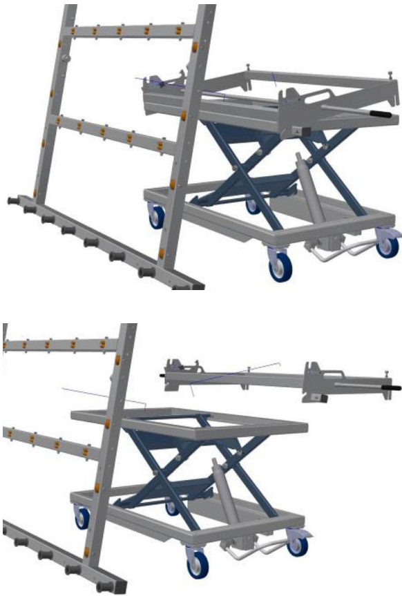
Abb. 6: Abbau der Schwenkvorrichtung
