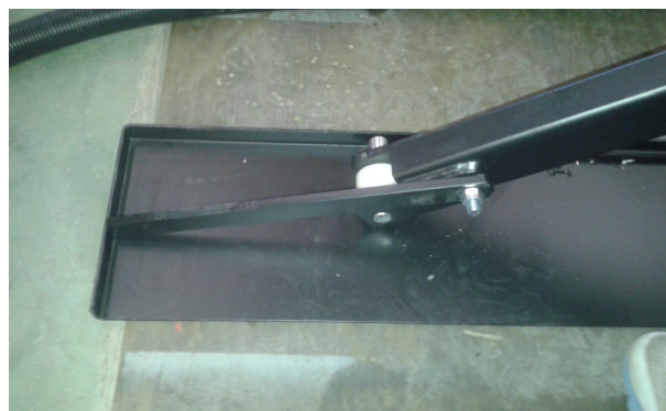
Abb. 6: Montierter Sicherungsbügel, ausgeklappt zur Arretierung
