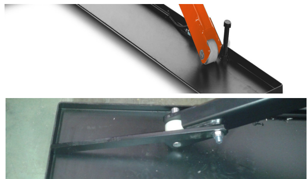
Abb. 7: Arretierung des Scherenhubtisches
