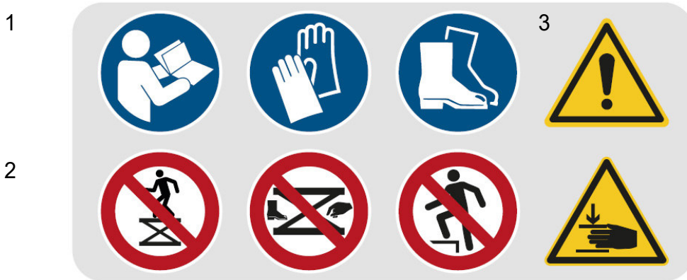
Abb. 1-1: Sicherheitskennzeichnungen: 1 Gebotszeichen: Gebrauchsanweisung beachten, Handschutz benutzen, Fußschutz benutzen | 2 Verbotsschilder: Auf die Tischfläche steigen verboten; Einstecken der Körperteile verboten, Aufsteigen verboten | 3 Warnzeichen: Allgemeines Warnzeichen, Warnung vor Handverletzungen
