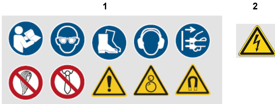
Abb. 1-1: Sicherheitskennzeichnungen - 1 Gebotszeichen: Anleitung beachten, Augenschutz benutzen, Fußschutz benutzen, Gehörschutz benutzen, Netzstecker ziehen || Verbotssymbole: Bedienung mit langen Haaren verboten, Bedienung mit Krawatten verboten || Warnzeichen: Allgemeines Warnzeichen, Warnung vor gegenläufigen Rollen, Warnung vor magnetischem Feld || 2 Warnzeichen: Warnung vor elektrischer Spannung
