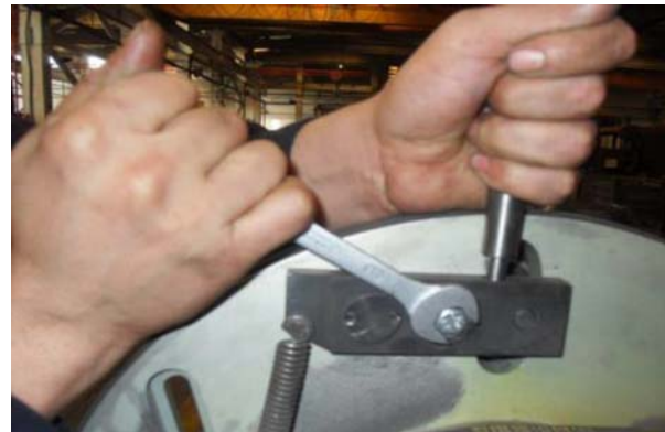
Abb. 26: Freigeben der Spannrolle
