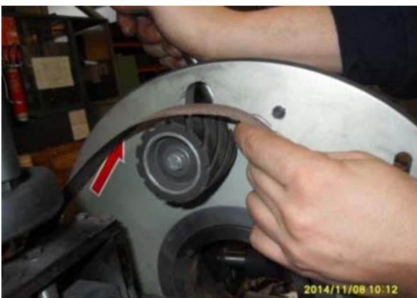
Abb. 24: Entfernen der Schleifbänder
