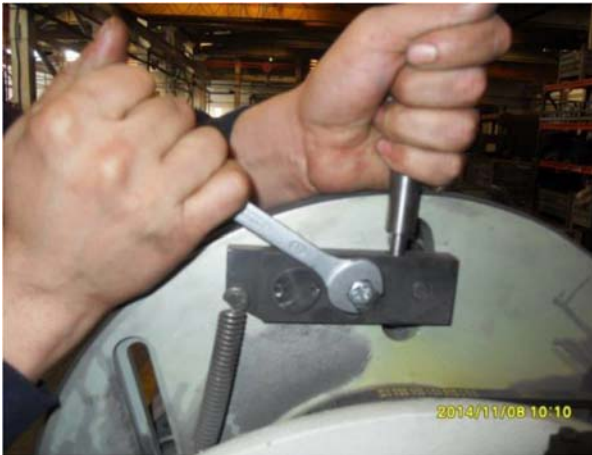
Abb. 22: Hinunterdrücken der Spannrollen
