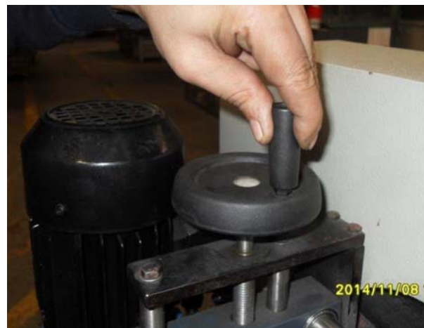
Abb. 18: Drehrad zur Einstellung der Höhe der Förderräder
