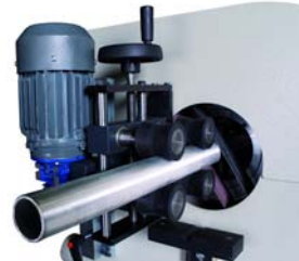
Abb. 19: Verarbeitung von rundem Material
