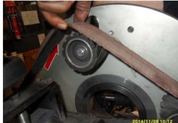
Abb. 25: Platzieren der neuen Spannbänder
