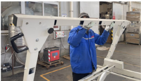
Abb. 5-13: Montage Oberer Querträger mit Winkelplatten
