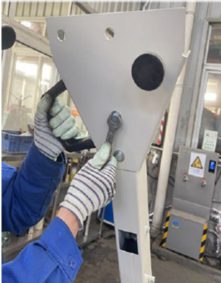
Abb. 5-9: Montage der festen Winkelplatte an der Oberseite der Schwenkachse
