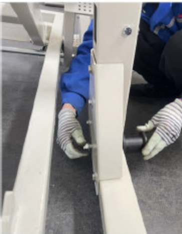
Abb.5-15: Schwenkachse und Rollen montieren
