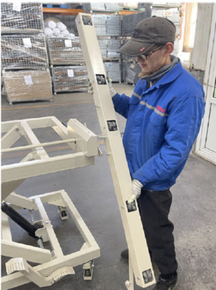
Abb. 5-6: Montage der Schwenkachse
