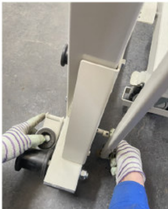
Abb.5-7: Montage der Hauptwelle
