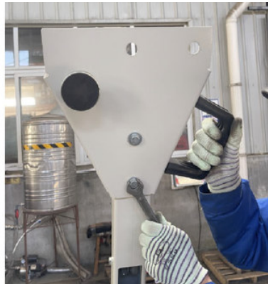
Abb. 5-10: Montage der festen Winkelplatte an der Unterseite der Schwenkachse
