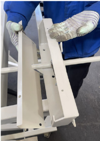
Abb.5-3: Demontage der Abdeckungen
