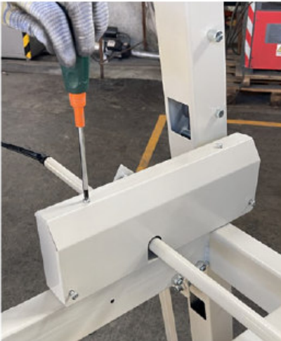
Abb. 5-5: Montage der Abdeckung
