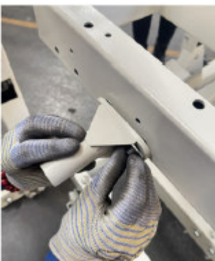
Abb.5-16: Montage des Befestigungssitzes für die Gasdruck-Feder
