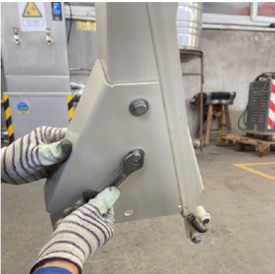
Abb. 5-10: Montage der festen Winkelplatte an der Unterseite der Schwenkachse
