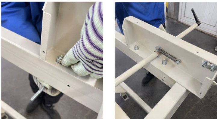
Abb.5-4: Linken und rechten Rahmen mit der Hubtischplattform verbinden
