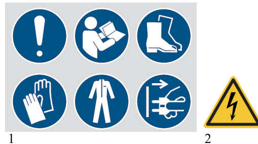
Abb. 1: Sicherheitshinweise. 1 Gebotszeichen: allgemeines Gebotszeichen, Anleitung beachten, Fußschutz benutzen, Handschutz benutzen, Schutzkleidung benutzen, Netzstecker ziehen | 2 Warnzeichen: Warnung vor elektrischer Spannung
