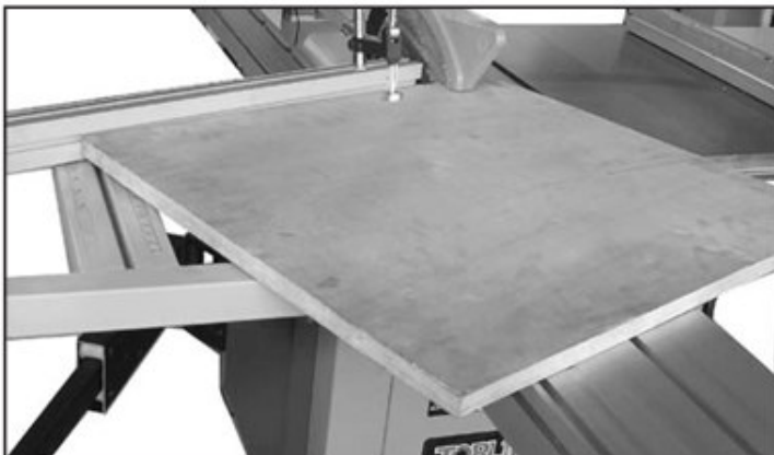
Abb. 7-4: Gehrungsschnitt mit Längenanschlag
