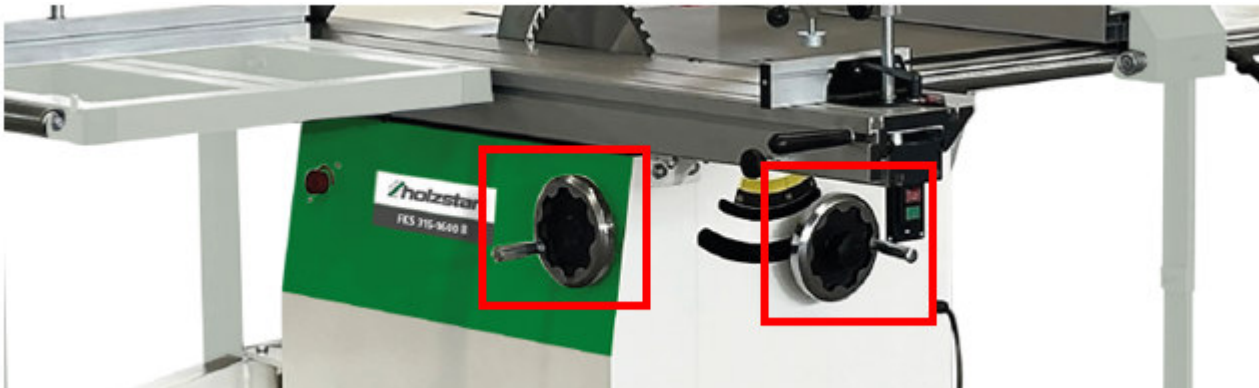
Abb.5-3: Montage der Handräder
