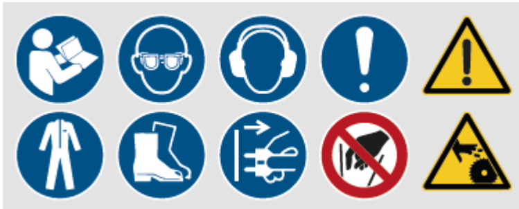
Abb. 1-1: Sicherheitskennzeichnung - Gebotszeichen: Gebrauchsanweisung beachten, Augenschutz benutzen, Gehörschutz benutzen, Allgemeines Gebotszeichen, Schutzkleidung benutzen, Fußschutz benutzen, Netzstecker ziehen | 2 Verbotsschilder: Hineinfassen verboten! | 3 Warnzeichen: Warnung vor Gefahr durch rotierendes Sägeblatt, Allgemeines Warnzeichen
