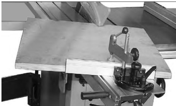
Abb. 42: Gehrungsschnitt mit Winkelanschlag
