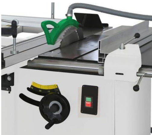
Abb. 43: Handrad für die Höhenverstellung des Sägeblatts
