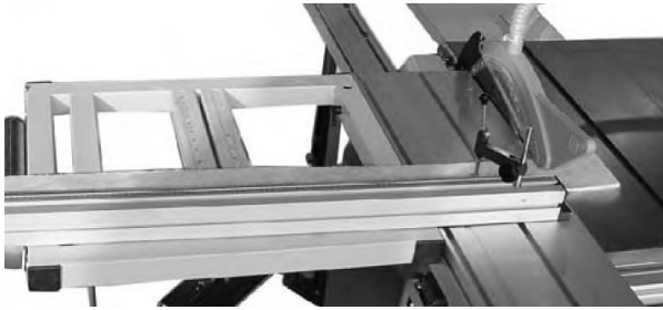
Abb. 36: Anschlag in hinterer Position für kleinere Werkstücke
