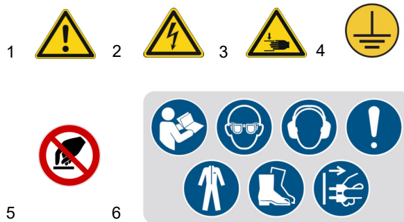
Abb. 1: Sicherheitskennzeichnungen 1 Warnung vor Gefahren | 2 Warnung vor gefährlicher elektrischer Spannung | 3 Warnung vor Verletzungsgefahr für die oberen Gliedmaßen | 4 Erdungssymbol | 5 Verbot für Berührung | 6 Sicherheitshinweise
