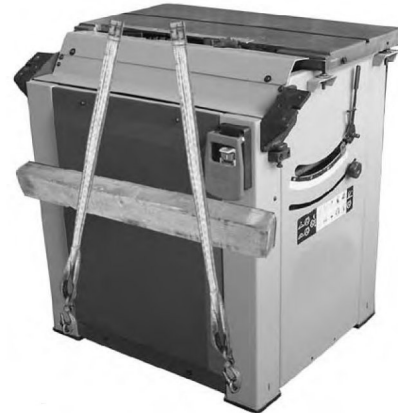
Abb. 9: Vorbereitung für den Transport
