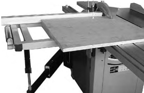
Abb. 32: Sägebetrieb mit Schiebeschlitten
