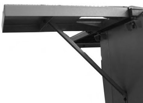
Abb. 13: Hinteren Erweiterungstisch anschrauben
