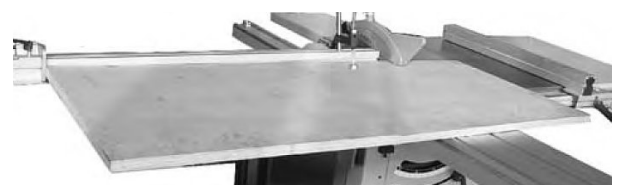
Abb. 35: Anschlag in vorderer Position für große Werkstücke
