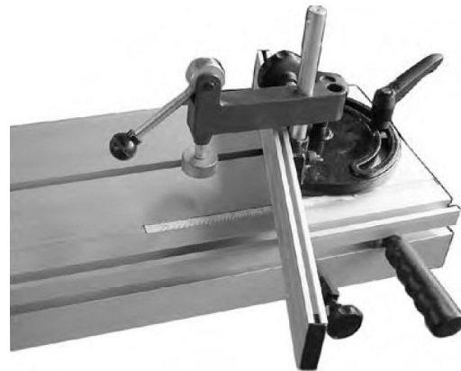
Abb. 40: Skalen für Gehrungsschnitte am Winkelanschlag
