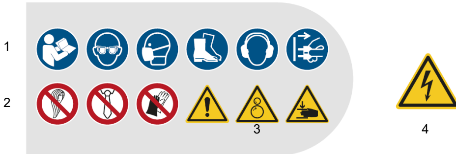
Abb.1-1: Sicherheitskennzeichnung - 1 Gebotszeichen: Gebrauchsanweisung beachten, Augenschutz benutzen, Mundschutz benutzen, Fußschutz benutzen, Gehörschutz benutzen, Netzstecker ziehen, | 2 Verbotssymbole: Bedienung mit langen Haaren verboten!, Bedienung mit Krawatten verboten!, Benutzen von Handschuhen verboten! | 3 Warnzeichen: allgemeines Warnzeichen!, Warnung vor Rotierenden Walzen!, Warnung vor Handverletzungen! | 4 Warnzeichen: Warnung vor elektrischer Spannung!
