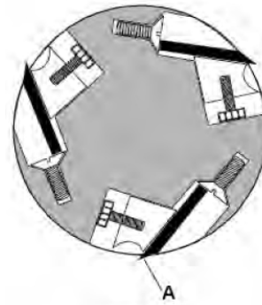
Abb. 17: Querschnitt durch den Messerkopf
