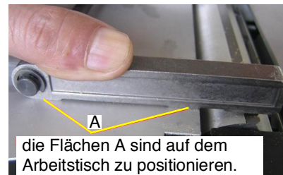
Abb. 29: Einstellen der Hobelmesser auf Fläche B
