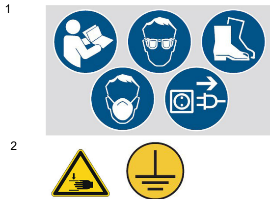
Abb. 1: Sicherheitskennzeichnungen an der Sandstrahlkabine SSK 5 1 Gebotszeichen: Anleitung beachten, Augenschutz benutzen, Fußschutz benutzen, Maske benutzen, Netzstecker ziehen | 2 Warnzeichen: Warnung vor Handverletzungen, Vor Benutzung erden
