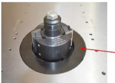
Abb.9-6: Montage einer Messerwelle
