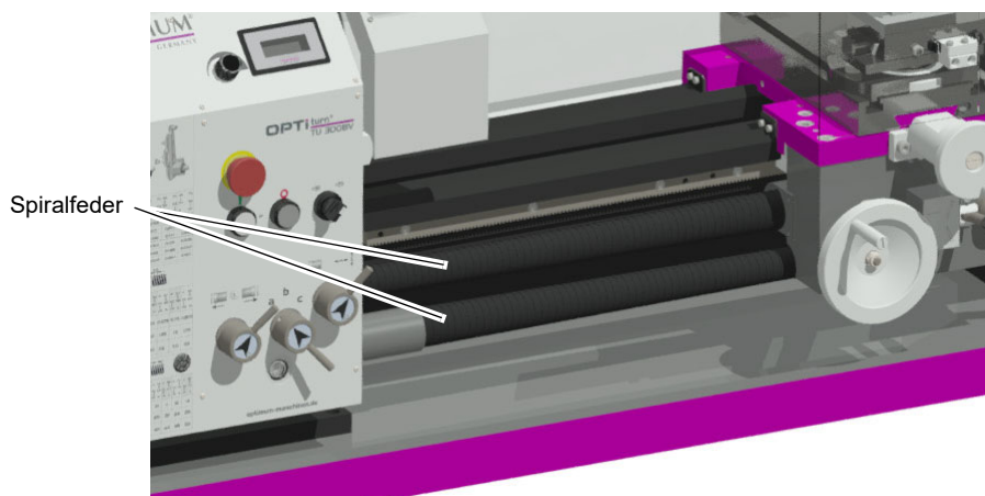
Abb. 1-4: Leit- und Zugspindel mit Schutzabdeckung
