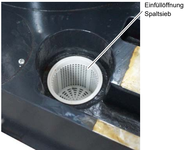
Abb.3-6: Kühlmittelbehälter im Maschinenfuß
