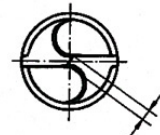
Querschneidenlänge 10% vom Bohrer - Ø
