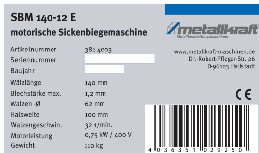
Abb. 2: Typenschild SBM 140-12 E
