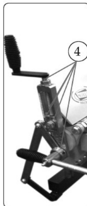
Elemente des Hebemechanismus der Oberwange - vierseitiges Blechbiegen
