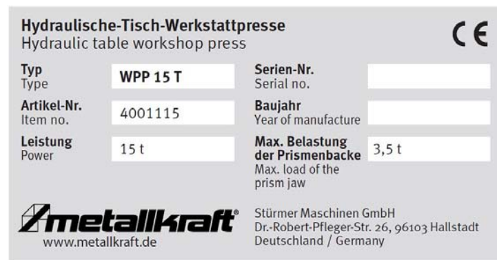
Abb. 3: Typenschild und CE-Kennzeichnung der Tisch-Werkstattpresse
