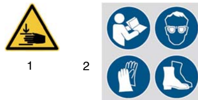
Abb. 1: Sicherheitskennzeichnungen - 1 Warnzeichen: Gefahr für Handverletzungen 2 Gebotszeichen: Betriebsanleitung lesen, Augenschutz, Handschutz, Sicherheitsschuhe tragen
