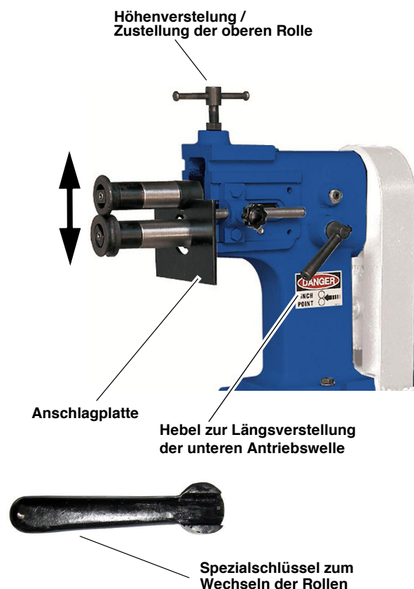
Abb. 12: Auswechseln der Rollen
