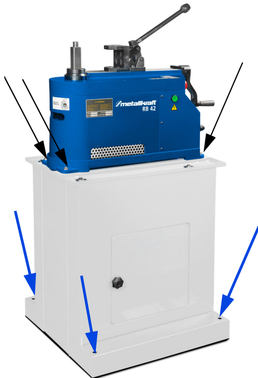
Abb. 14: Verankerung der Rohrbiegemaschine
