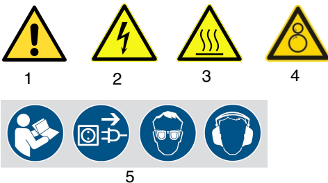
Abb. 1: Sicherheitskennzeichnungen - 1 Warnung vor Gefahren - 2 Warnung vor gefährlicher elektrischer Spannung - 3 Warnung vor heißen Oberflächen - 4 Warnung vor Einzugsgefahr durch rotierende Maschinenteile - 5 Gebotszeichen: Gebrauchsanweisung lesen, Netzstecker ziehen, Augenschutz tragen, Gehörschutz tragen
