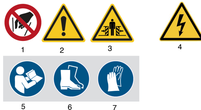
Abb. 1: Sicherheitskennzeichnungen: Verbotssymbol: | 1 Hineinfassen verboten - Warnzeichen: | 2 allgemeines Warnzeichen | 3 Warnung vor Quetschgefahr - | 4 Warnung vor gefährlicher elektrischer Spannung - Gebotssymbol: | 5 Betriebsanleitung lesen | 6 Sicherheitsschuhe tragen | 7 Schutzhandschuhe tragen.
