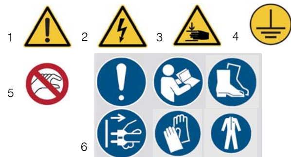
Abb. 1: Sicherheitskennzeichnungen - 1 Warnung vor Gefahren | 2 Warnung vor gefährlicher elektrischer Spannung | 3 Warnung vor Quetschgefahr für die oberen Gliedmaßen | 4 Erdungssymbol | 5 Verbot für Berührung | 6 Sicherheitsgebote, Schutzausrüstung
