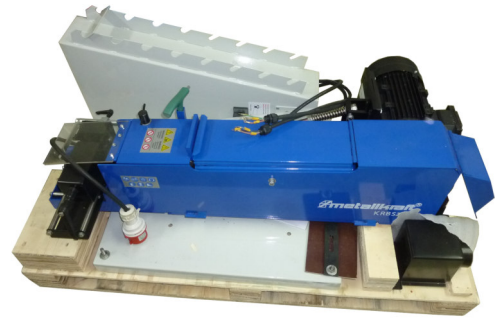
Abb. 4: Montage der Rohrbandschleifmaschine
