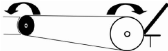
Abb. 18: Betriebsarten: Rohrschleifer (L) links, Bandschleifer (R) rechts
