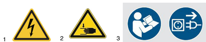
Abb. 1: Sicherheitskennzeichnungen - 1 Warnung vor gefährlicher elektrischer Spannung 2 Quetschgefahr für obere Gliedmaßen 3 Gebotszeichen
