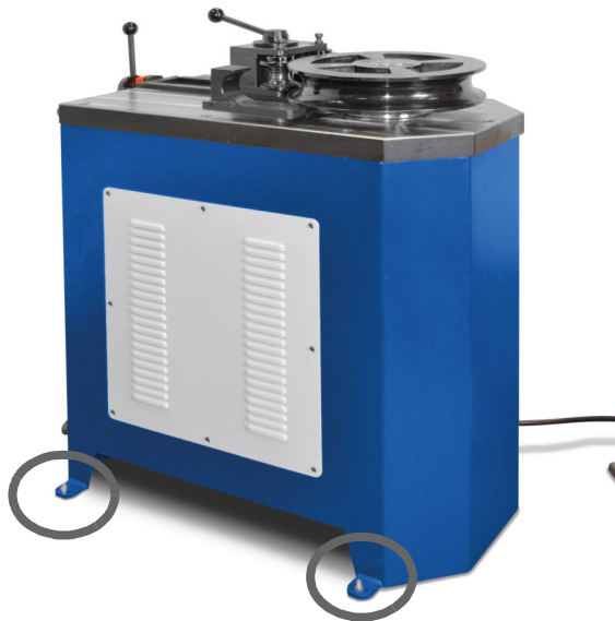
Abb. 9: Verankerung der Rohrbiegemaschine
