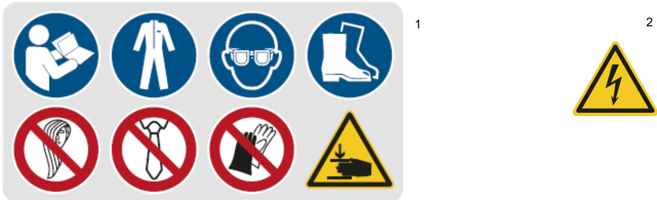
Abb. 1-2: Sicherheitskennzeichnungen - 1 Gebotszeichen: Gebrauchsanweisung/ Betriebsanleitung beachten, Schutzkleidung benutzen, Augenschutz benutzen, Sicherheitsschuhe tragen, Bedienung mit langen Haaren verboten, Bedienung mit Krawatte verboten, Bedienung mit Handschuhen verboten, Warnung vor einer Gefahrenstelle: Warnung vor Handverletzungen 2 Warnzeichen: Warnung vor elektrischer Spannung
