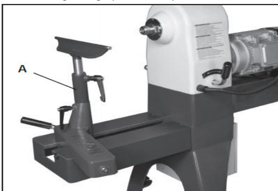
Abb. 7-14: Montage der Verlängerung an die linke Seite des Maschinenbettes
