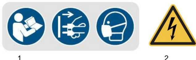
Abb.1-1: Sicherheitskennzeichnungen - 1 Gebotszeichen: Anleitung beachten, Netzstecker ziehen, Maske benutzen | 2 Warnung vor elektrischer Spannung
