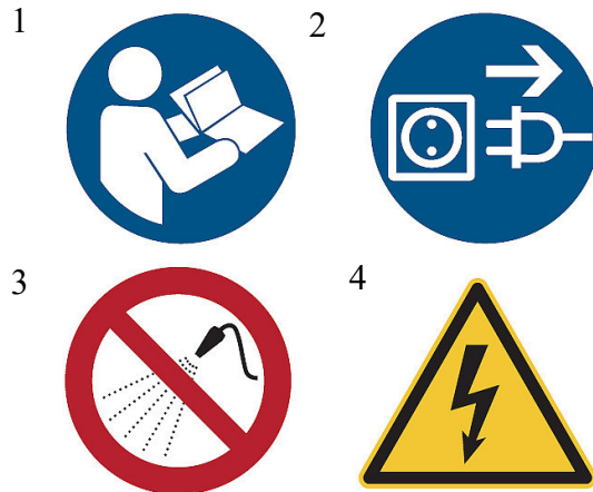
Abb. 1: Sicherheitshinweise am Spezialsauger: 1 Anleitung beachten | 2 Netzstecker ziehen | 3 Mit Wasser spritzen verboten | 4 Warnung vor elektrischer Spannung
