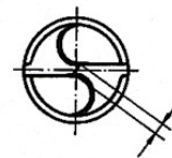
Querschneidenlänge 10% vom Bohrer - Ø
