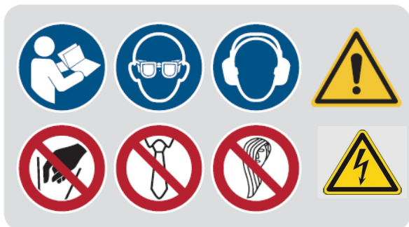
Abb. 1: Sicherheitskennzeichnungen - Gebotszeichen: Gebrauchsanweisung lesen, Augenschutz tragen, Gehörschutz tragen | Warnzeichen: Allgemeines Warnzeichen | Elektrische Spannung | Verbotsschilder: Hineinfassen verboten, Krawatte tragen verboten, offene Haare tragen verboten
