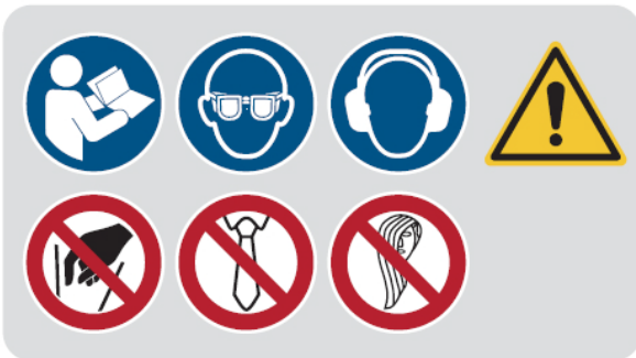
Abb. 1: Sicherheitskennzeichnungen - Gebotszeichen: Gebrauchsanweisung lesen, Augenschutz tragen, Gehörschutz tragen | Warnzeichen: Allgemeines Warnzeichen | Verbotsschilder: Hineinfassen verboten, Krawatte tragen verboten, offene Haare tragen verboten
