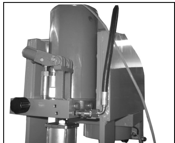
Abb. 15: Der kurze Schlauch montieren
