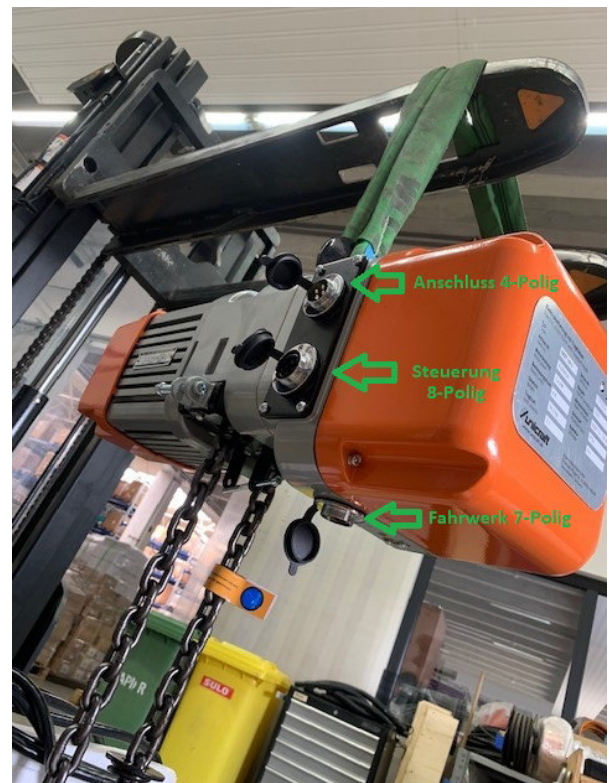
Abb. 9: Verbindung der Anschlüsse
