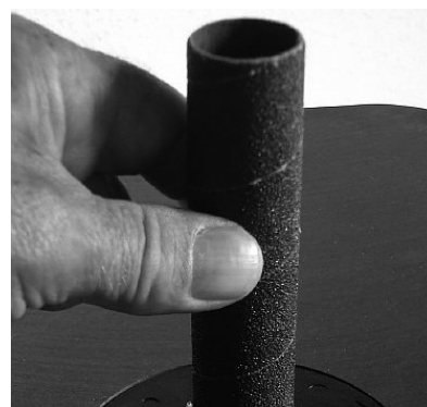
Abb. 8: Schleifhülse auf Schleifwalze aufsetzen
