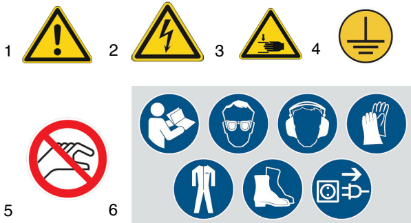
Abb. 1: Sicherheitskennzeichnungen 1 Warnung vor Gefahren | 2 Warnung vor gefährlicher elektrischer Spannung | 3 Warnung vor Quetschgefahr für die oberen Gliedmaßen | 4 Erdungssymbol | 5 Verbot für Berührung | 6 Sicherheitshinweise
