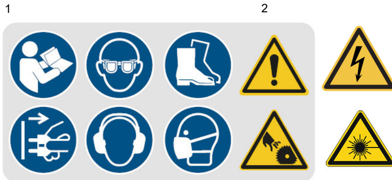
Abb. 1-2: Sicherheitskennzeichnungen - 1 Gebotszeichen: Anleitung beachten, Augenschutz benutzen, Fußschutz benutzen, Netzstecker ziehen, Gehörschutz benutzen, Maske benutzen | 2 Warnzeichen: allgemeines Warnzeichen, Warnung vor elektrischer Spannung, Warnung vor Gefahr durch rotierendes Sägeblatt, Warnung vor Laserstrahlen
