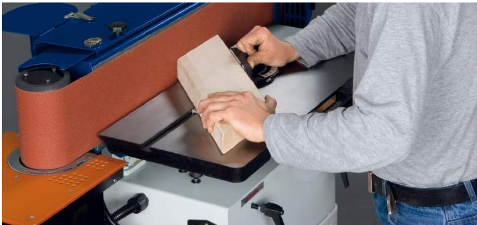
Abb.9-3: Arbeiten mit Gehrungsanschlag
