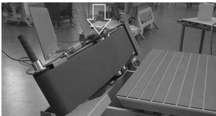
Abb.6-12: Montage Schleifschuh 150 F PRO
