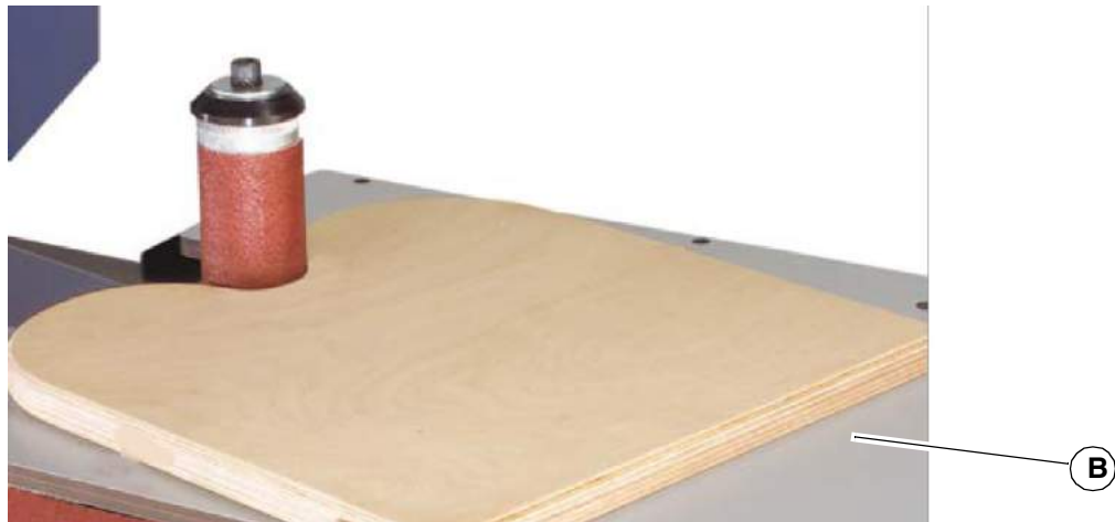
Abb.9-4: Rundscheifen an der Schleifhülsenvorrichtung
