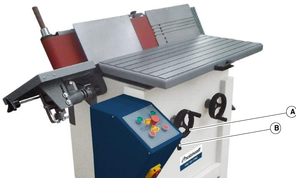
Abb. 8-6: Einstellung Schleifaggregat KSO 150 F PRO
