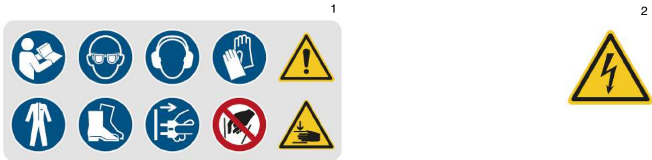
Abb. 1-2: Sicherheitskennzeichnungen - 1 Gebotszeichen: Gebrauchsanweisung beachten, Augenschutz benutzen, Gehörschutz benutzen, Handschutz benutzen, Schutzkleidung benutzen, Fußschutz benutzen, Netzstecker ziehen, Berühren verboten, Warnung vor Handverletzungen 1 2 2 Warnzeichen: Allgemeines Warnzeichen, Warnung vor elektrischer Spannung
