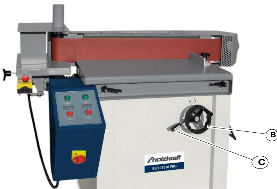
Abb.8-8: Einstellung Schleifaggregat KSO 150 M PRO
