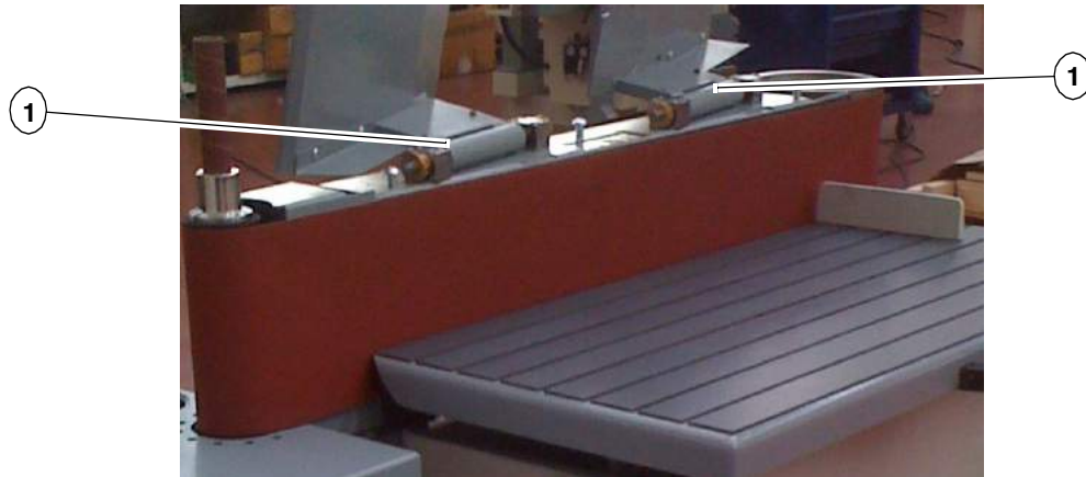
Abb. 6-13: Einstellen der Führung des Schleifschuhs
