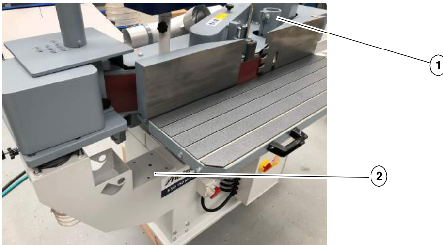
Abb.6-10: Aufnahmen Vorschubaggregat KSO 150 M F 3 PRO und KSO 150 M F 4 PRO
