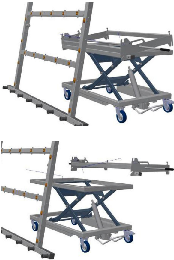
Abb. 6: Abbau der Schwenkvorrichtung
