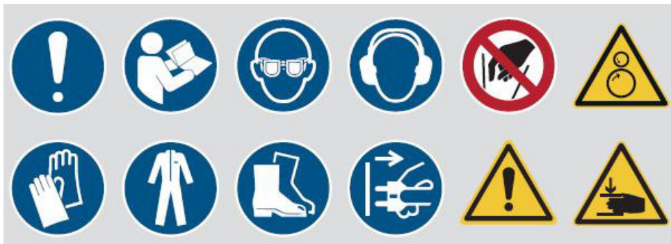
Abb. 1-2: Sicherheitskennzeichnung - Verbotssymbol: Hineinfassen verboten! | Gebotszeichen: Gebrauchsanweisung beachten, Netzstecker ziehen, Augenschutz benutzen, Gehörschutz benutzen, Fußschutz benutzen, Handschutz benutzen, Schutzkleidung benutzen | Warnzeichen: Warnung vor Handverletzungen, Warnung vor elektrischer Spannung, Warnung vor gegenläufigen Rollen!
