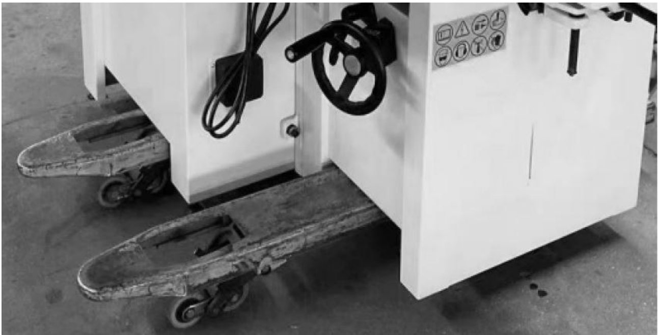
Abb. 3-1: Transport der Maschine mit einem Hubwagen oder Gabelstapler
