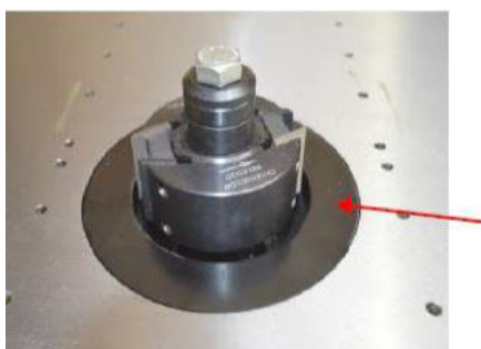
Abb.8-6: Montage einer Messerwelle
