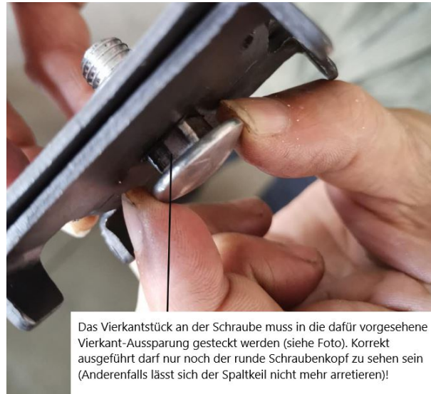
Abb. 19: Spaltkeil montieren Teil 1
