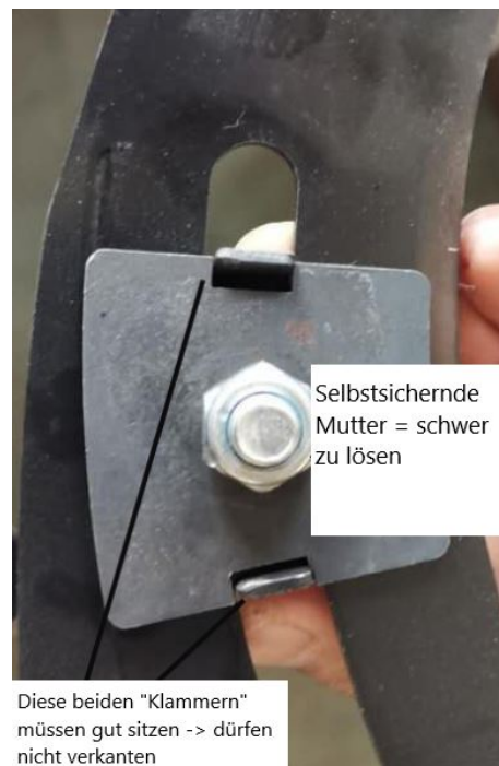
Abb. 21: Spaltkeil montieren Teil 3
