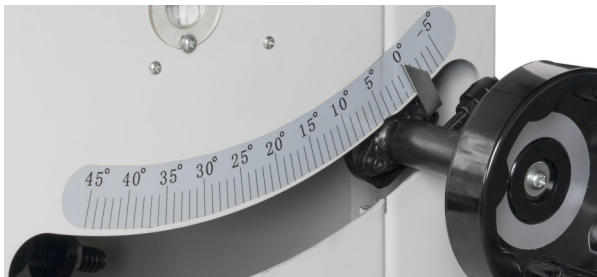
Abb. 20: Skala zur Einstellung des Fräser-Neigungswinkels
