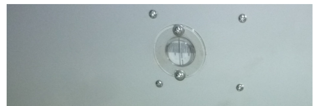
Abb. 18: Skala zur Höhenverstellung des Fräsers
