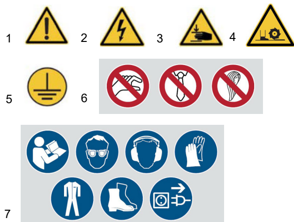
Abb. 1: Sicherheitskennzeichnungen 1 Warnung vor Gefahren | 2 Warnung vor gefährlicher elektrischer Spannung | 3 Warnung vor Quetschgefahr für die oberen Gliedmaßen | 4 Warnung vor rotierenden Messern | 5 Erdungssymbol | 6 Verbotssymbole | 7 Sicherheitshinweise
