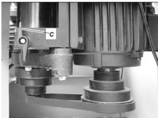
Abb.5-18: Ändern der Drehzahl
