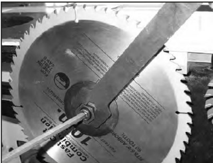
Abb. 5-11: Wechseln des Hauptsägeblatts
