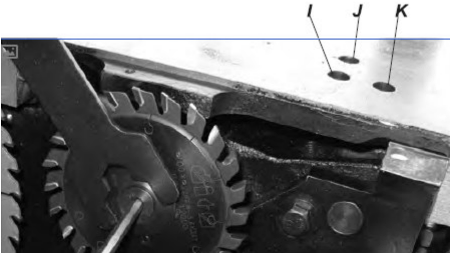
Abb. 5-15: Einstellen des Vorritzer Sägeblatts
