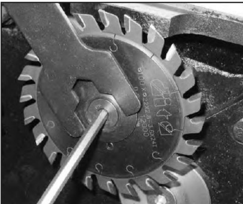
Abb.5-12: Änderung und Anpassung des Vorritzer Sägeblatts
