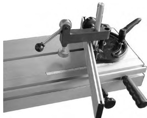
Abb. 40: Skalen für Gehrungsschnitte am Winkelanschlag
