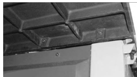
Abb. 10: Erweiterungstisch aus Gusseisen montieren
