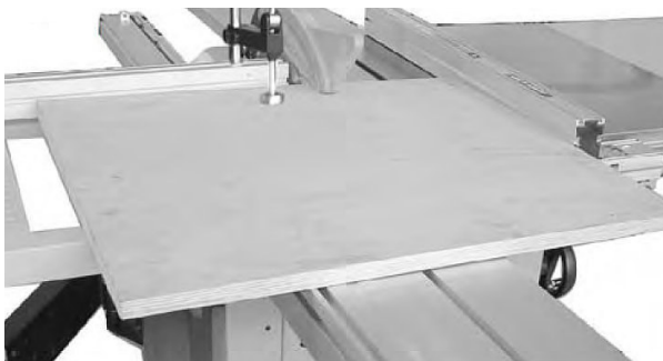
Abb. 38: Anschlag als Maßstab
