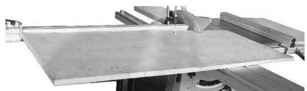
Abb. 35: Anschlag in vorderer Position für große Werkstücke
