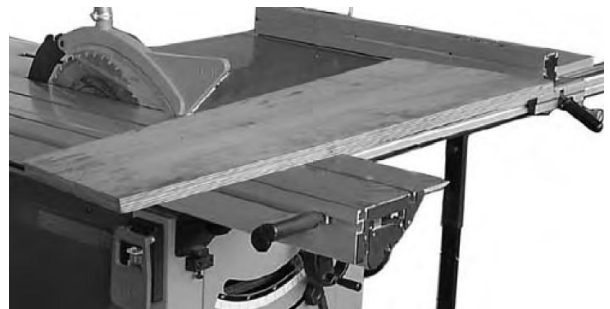
Abb. 34: Sägebetrieb mit dem Säge Tisch
