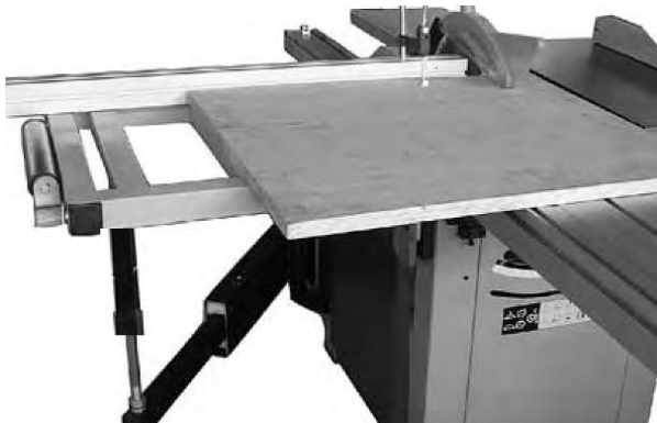
Abb. 32: Sägebetrieb mit Schiebeschlitten
