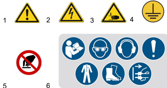
Abb. 1: Sicherheitskennzeichnungen 1 Warnung vor Gefahren | 2 Warnung vor gefährlicher elektrischer Spannung | 3 Warnung vor Quetschgefahr für die oberen Gliedmaßen | 4 Erdungssymbol | 5 Verbot für Berührung | 6 Sicherheitshinweise
