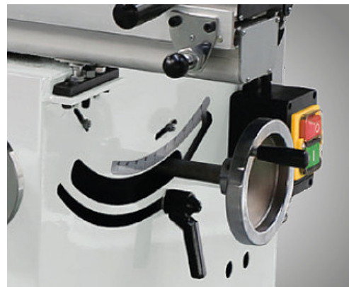
Abb. 21: Handrad für die Höhenverstellung des Sägeblatts
