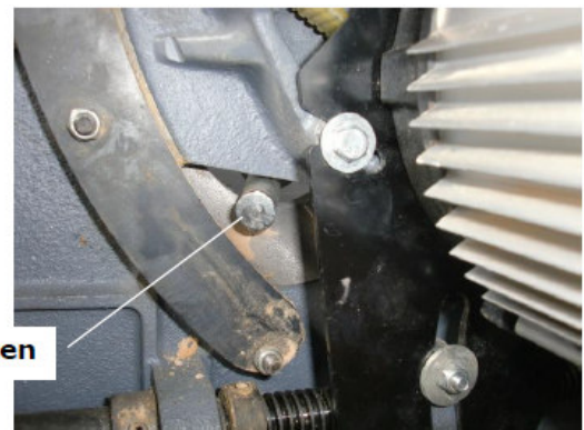
Abb. 5: Einstellung der Riemen ­ spannung
