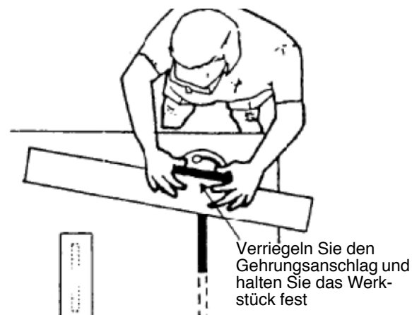
Abb. 34: Diagonalschnitt mit dem Diagonalanschlag
