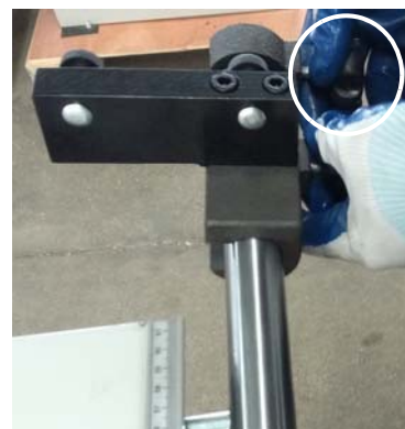
Abb. 15: Aufschieben des Trägers auf die Führungsschiene
