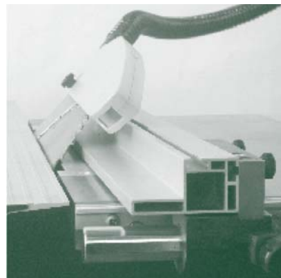
Abb. 33: Abgeschrägte Kante schneiden
