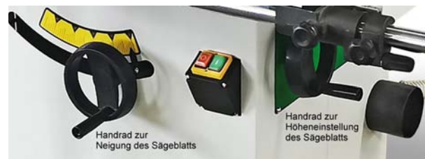
Abb. 37: Einstellungsmöglichkeiten des Sägeblatts
